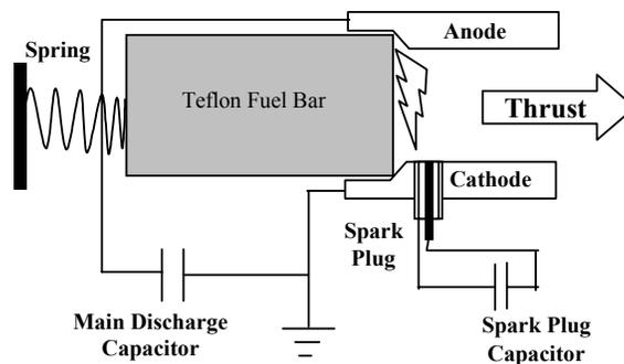
**Figure 2. PPT Diagram**
